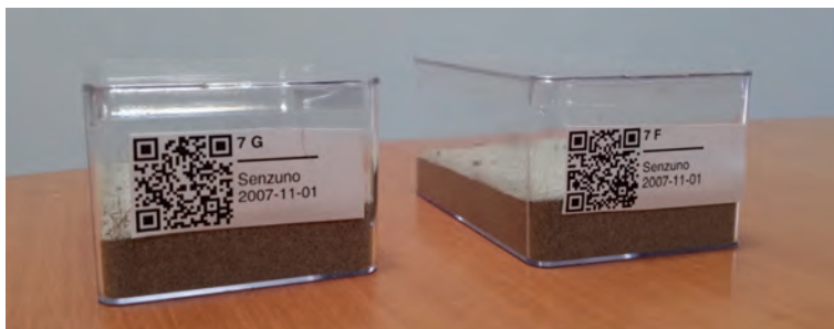
Figura 6. Scatoline per esposizione campioni con Nome campione, Località, Data e QR Code per collegamento alla scheda dati online.
