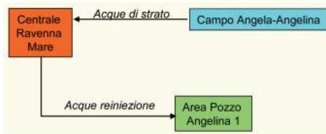
Figura 9 - Schema semplificato del flusso delle acque iniettate nella fase di early injection .
