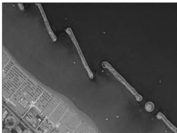
Figura 1 - Opera distaccata emersa. Esempio di mappatura: vengono tracciati i limiti della porzione emersa dell'opera, visibili al momento dello scatto della foto aerea.
