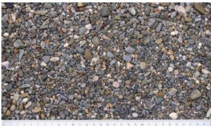
Figura 10 - Ghiaia con granuli di dimensioni comprese fra 0.3 e 20 mm (a sinistra) e lo stesso campione fotografato da 1 m di distanza con interposta una Tavola Munsell usata come piano di messa a fuoco.
