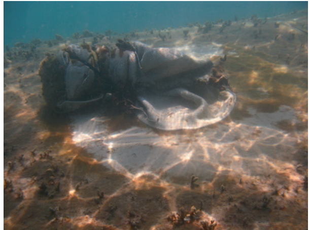
Figura 9 - Abrasione sulla superficie del tubo causata dalla manichetta di riempimento Settembre 2009.
