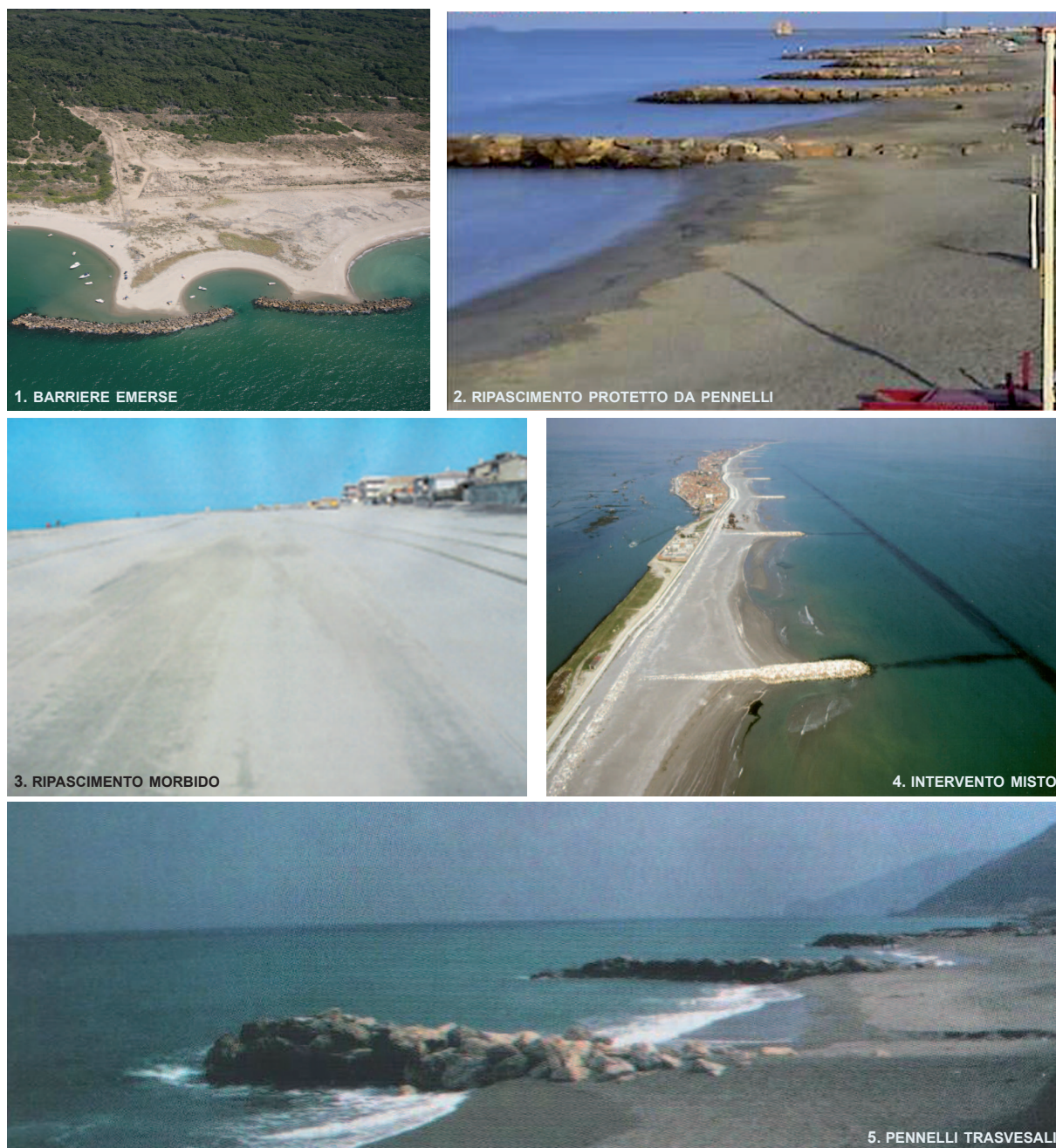
Figura 2 -Le cinque tecniche di difesa mostrate agli intervistati (1. fonte: Provincia di Livorno; 2. fonte: www.beachmed.it ; 4. fonte: www.delos.unibo.it ; 5. fonte: Studi costieri 10).
