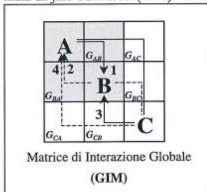
Figura 4 - Esempio di matrice GIM a tre parametri (A, B e C).
