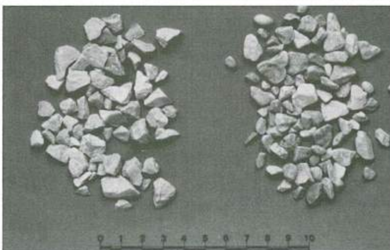
Figura 7 - Arrotondamento dei granuli calcarei nei primi due anni dopo il ripascimento per le principali frazioni granulometriche utilizzate. A sinistra il materiale originale, a destra quello elaborato. Non è stato ovviamente valutato l'arrotondamento della sabbia di mare, versata per circa 7.500 mc sul totale di 22.873 mc.
