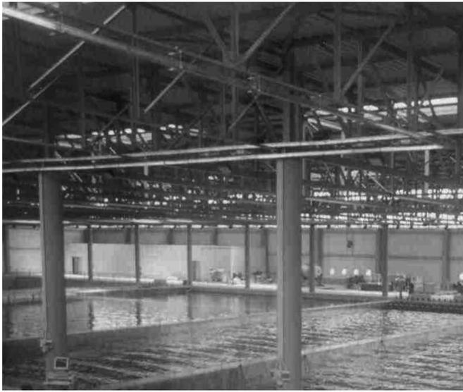
Figura 3 - Bacino con ondogeno in dotazione al Laboratorio di Ricerca e Sperimentazione per la Difesa delle Coste del Politecnico di Bari (lungo 90 m, largo 50 m e profondo 1.2 m) in cui è possibile riprodurre fronti d'onda anche di 30 m.
