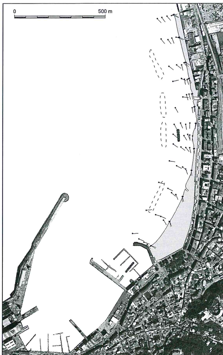
Figura 35 - Flussi sedimentari derivanti dall'applicazione del metodo di Geo e Collins (1992).
